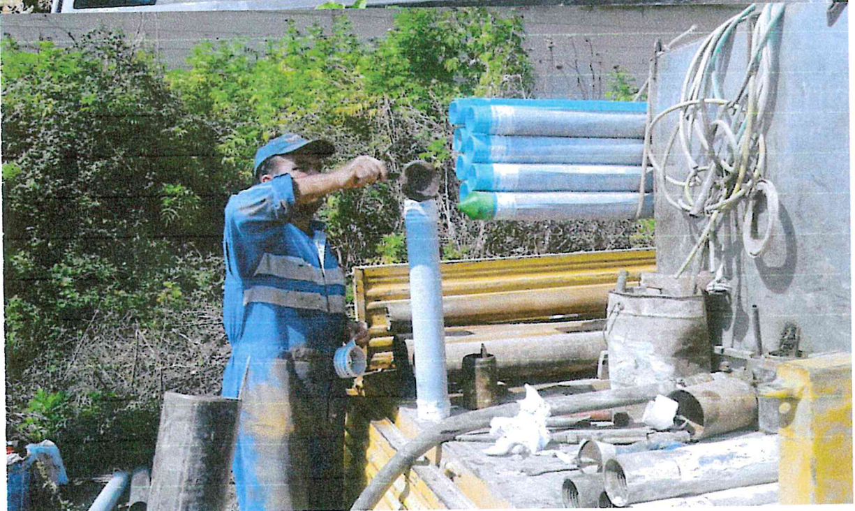
Prelievo del campione indisturbato C1 del sondaggio S1 da 15,50 a 16,00 m
