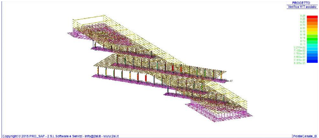
Pilastri : Verifica V/T (lato acciaio)
