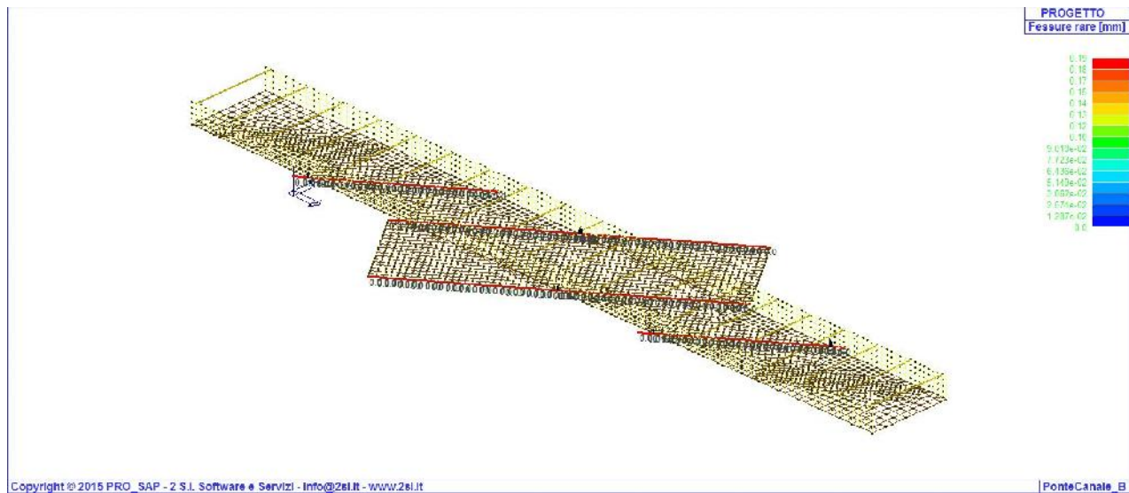
Travi : Apertura Fessure SLE Rare
